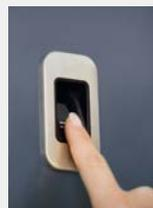
**Fingerscanner:** Die Fingerlinien werden nach dem Scannen des Fingers abgetastet und als einzigartiger binärer Fingercode abgespeichert und daraufhin erkannt.
